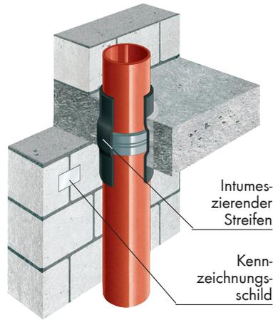
**Schottsystem für nicht brennbare Rohre bis 160 mm Außen-Ø und für brennbare Rohre bis 32 mm Außen-Ø, bestehend aus einem im Brandfalle aufquellenden Baustoff. F 90 nach DIN 4102 und LAR.**
